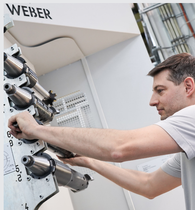
Einsetzen der Komplettwerkzeuge in die Be-/Entladestation.
