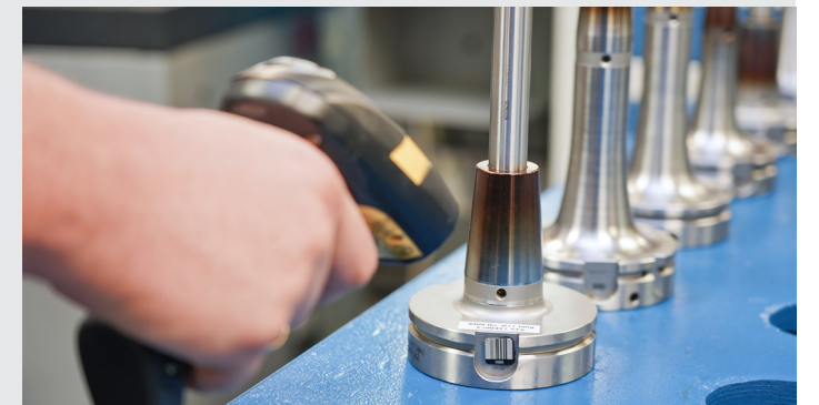
Eindeutige Werkzeugidentifikation via Barcode.
