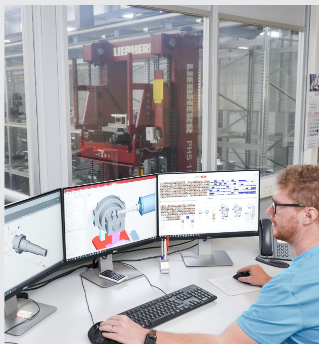
CAM-Programmierung mit direktem Zugriff auf Werkzeugdaten und -grafiken.
