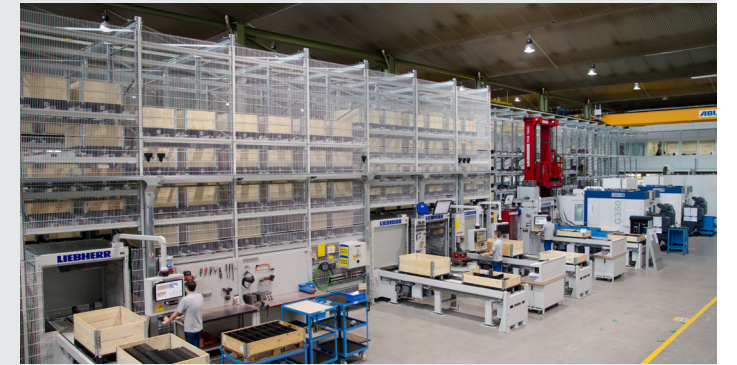
Das Hochregallager, in dem die Bauteile bis zur Bearbeitung aufgespannt zwischengelagert und bei Bedarf automatisch entnommen werden.
