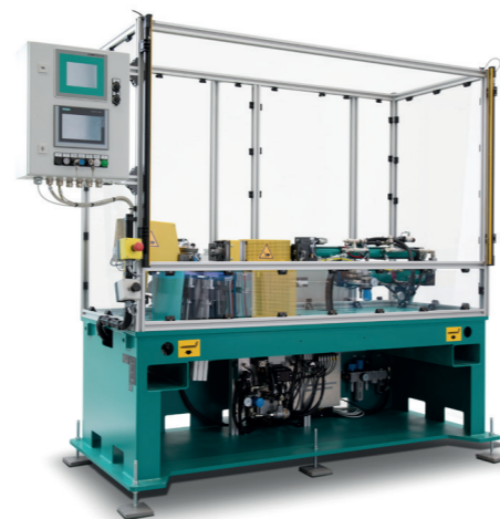
Pneumohydraulischer Handarbeitsplatz zum Montieren von Motorkomponenten
